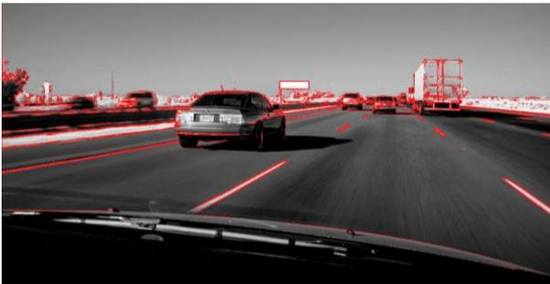
Pour cela, les photos réalisées par ses capteurs sont traitées par des algorithmes qui permettent de détecter les contours des objets qu'elle rencontre.
