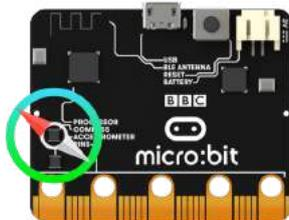
La boussole détecte le champ magnétique de la Terre, nous permettant de savoir quelle direction la micro:bit indique. La boussole doit être étalonnée avant de pouvoir être utilisée. Pour cela, on utilise `compass.calibrate()` qui exécute un petit jeu: au départ, micro:bit fait défiler "Tilt to fill screen". Ensuite, incliner micro:bit pour déplacer le point au centre de l'écran autour jusqu'à ce que vous ayez rempli la totalité de l'écran.
