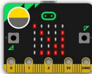
En inversant les LEDs d'un écran pour devenir un point d'entrée, l'écran LED devient un capteur de lumière basique, permettant de détecter la luminosité ambiante.
