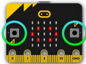
Il y a deux boutons sur la face avant du micro:bit (étiquetés A et B). On peut détecter quand ces boutons sont pressés, ce qui permet de déclencher des instructions sur l'appareil.
