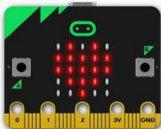
LED signifie Light Emitting Diode, Diode électroluminescente. La carte micro:bit en dispose de 25, toutes programmables individuellement, ce qui permet d'afficher du texte, des nombres et des images.
