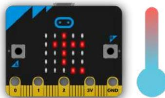
Le micro:bit n'a pas un capteur de température dédié. Au lieu de cela, la température fournie est en fait la température de la puce de silicium du processeur principal. Comme le processeur chauffe peu en fonctionnement (c'est un processeur ARM à grande efficacité), sa température est une bonne approximation de la température ambiante. L'instruction `temperature()` renvoie la température de la carte micro:bit en degrés Celsius.
