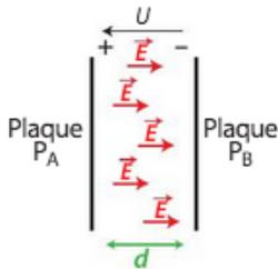
Lorsqu'on applique une tension  $U$  entre les armatures d'un condensateur plan, il apparaît un champ électrique  $\vec{E}$  uniforme.
